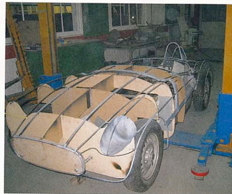
← «Ich hatte noch ein Chassis übrig», sagt Wagner. Die Karosserie für seinen MGA baute er selbst.
