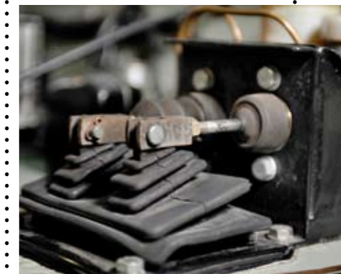
SO WARS FRÜHER: Raffinierte Gestängekonstruktion zum Synchronisieren der Doppelvergaseranlage, Bowdenzüge noch und noch, Kolbenstangen von Brems- und Kupplungs-Hauptzylinder mit mechanischer Verbindung zur Pedalerie.
