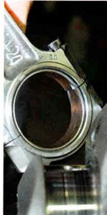
Links u. Mitte: Ein Maserati läuft nicht lange ohne Schmierung. Darunter leidet von der Ölpumpe bis zu den Pleuellagern so ziemlich alles. Rechts: Kopftuning an einem 5-Zylinder-Audi-Rennmotor.
